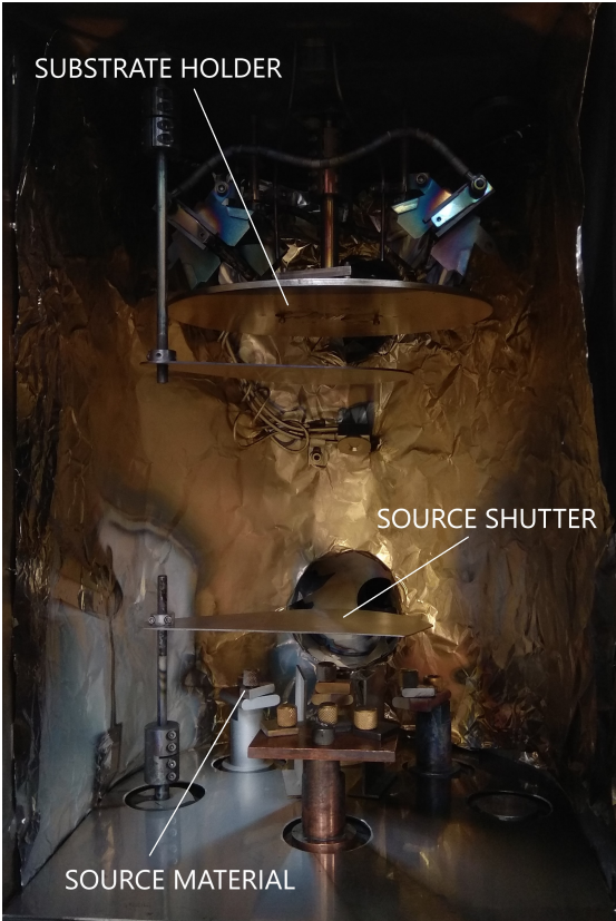
Figura 2.12: Kurt J. Lesker Thermal evaporator.
